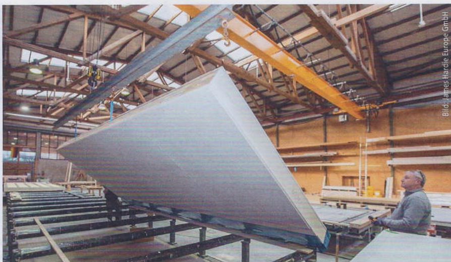
Per Kran werden die fertiggestellten Wandelemente für den Abtransport zur Baustelle bereitgestellt.
