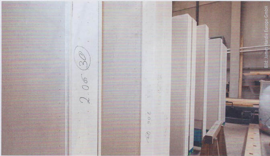
Das spezielle Markierungssystem erleichtert die Zuordnung der einzelnen Elemente und vereinfacht auf der Baustelle auch die Montage erheblich.
